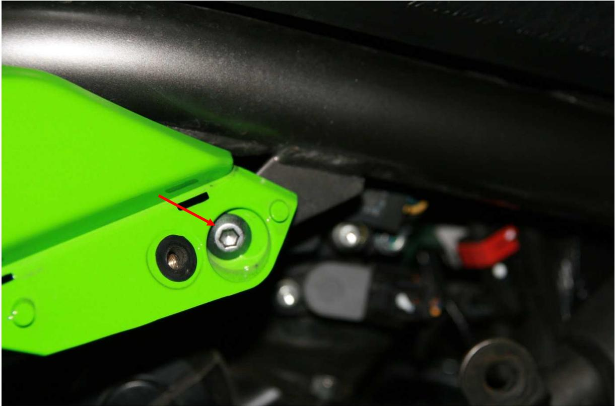
Puis dévissez l'écrou situé à l'avant bas du carénage (emplacement indiqué ci-dessous).
