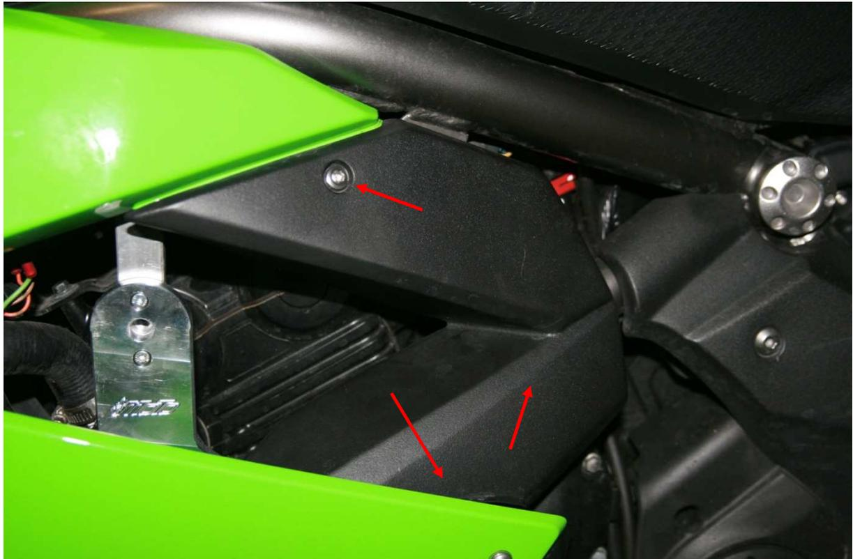
La seconde étape consiste à ôter la jupe noire. Celle-ci est tenue par 3 rivets en plastique noirs. Encore une fois c'est très simple, il suffit d'insérer un tournevis plat dans une des deux fentes de ce rivet (indiqué par la flèche dans l'image ci-dessous) puis de faire levier pour extraire la partie centrale. Reste à ôter ce rivet à présent déverrouillé.
