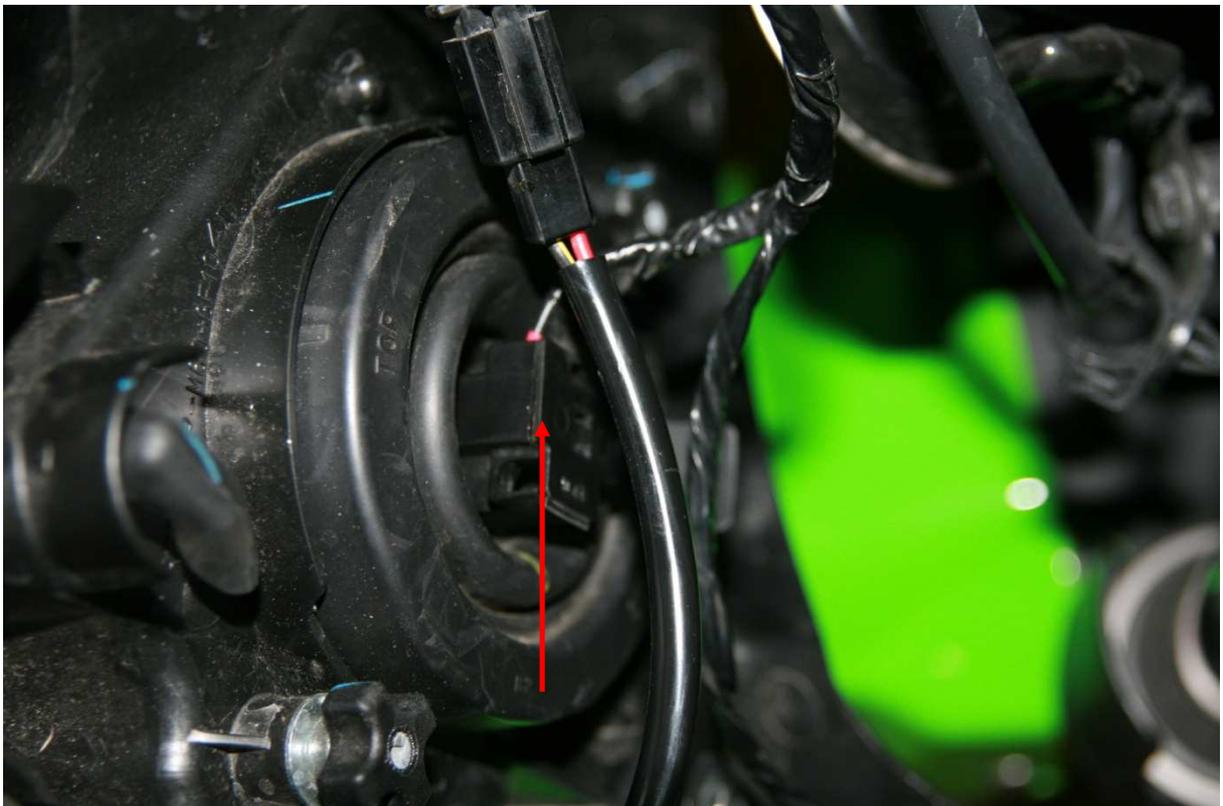
Dévissez les deux écrous qui tiennent le rétroviseur puis desserrez légèrement l'écrou qui tient la partie supérieur du bloc optique au carénage de manière à pouvoir faire tourner la pate de fixation qui fixe le bloc optique et le carénage à l'araignée.
