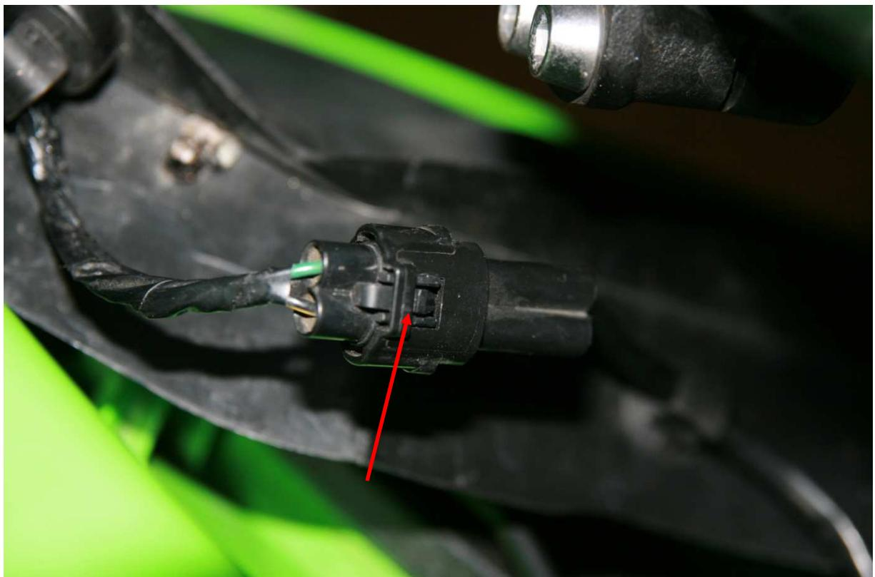
Débranchez les feux de positions (tirez sur la languette en caoutchouc, ils sont encastré dans une gaine en caoutchouc, n'ayez pas peur, ca résiste un peu...).
