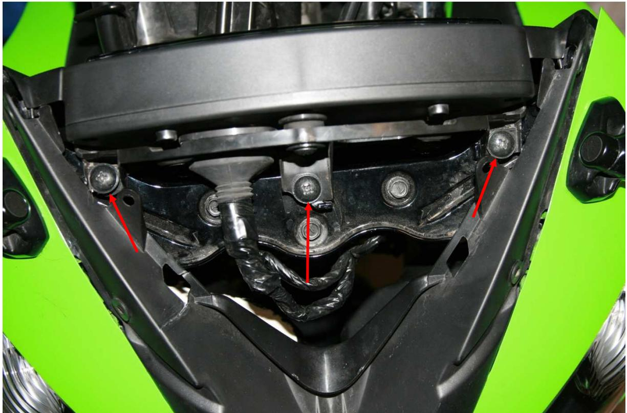
Ôtez les deux visses qui fixent le bloc compteur au carénage puis ôtez l'ensemble constitué du bloc-compteur et du carénage en plastique noir qui s'étendent jusqu'à ces visses depuis le bloc-compteur. Un léger mouvement de torsion sur ce plastique peut être nécessaire pour le dégager. J'ai bien dit léger...
